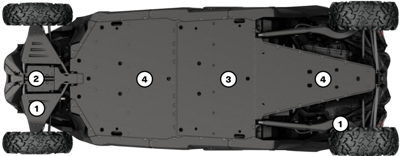
Nossas placas de plástico deslizam suave e silenciosamente sobre obstáculos, oferecendo excelente proteção em terrenos acidentados. Feito de polietileno termoformado com alto peso molecular (HMWPE) de 10mm (3/8 pol.) de espessura e resistente a abrasão.
